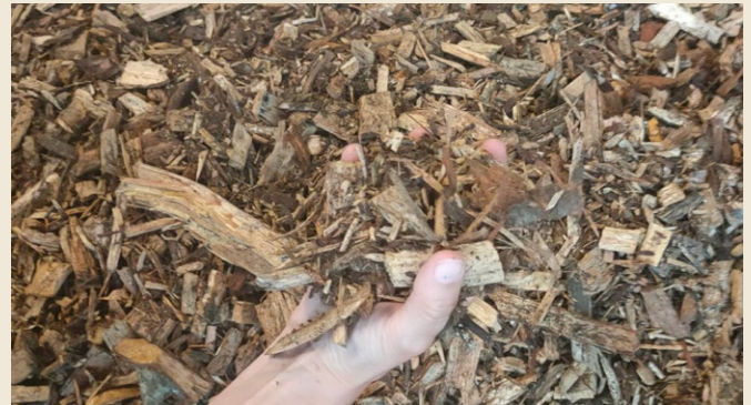
/ Du bois fourni localement servira à alimenter la chaudière.
